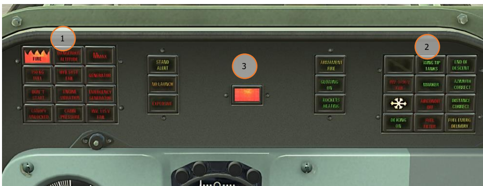
图 96：后驾驶舱内的告警灯和注意与提示灯面板
