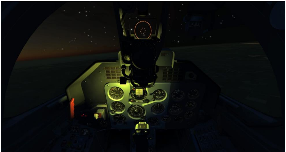
图 94： 应急仪表板照明开启时的驾驶舱
