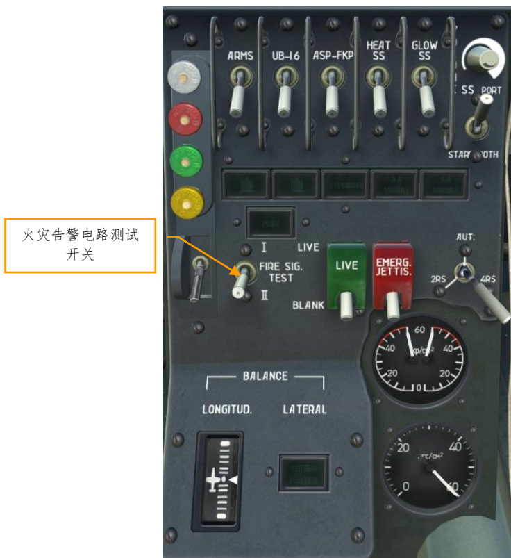
图 67：火灾告警电路测试开关
