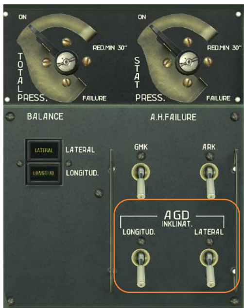
图 114: 姿态指引指示器 (ADI) 失效模拟控制器
