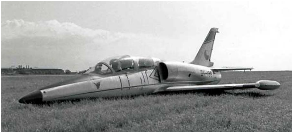
图 9：机腹紧急迫降后的X-06原型机
