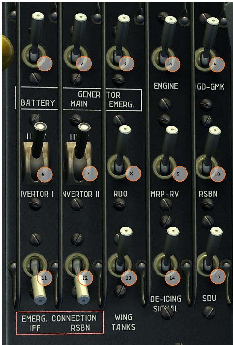
图 84：前驾驶舱主断路器开关面板
