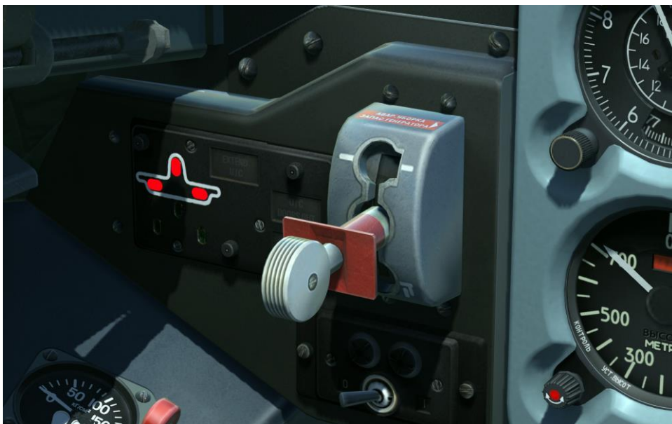
图 46: 后驾驶舱起落架收放手柄
