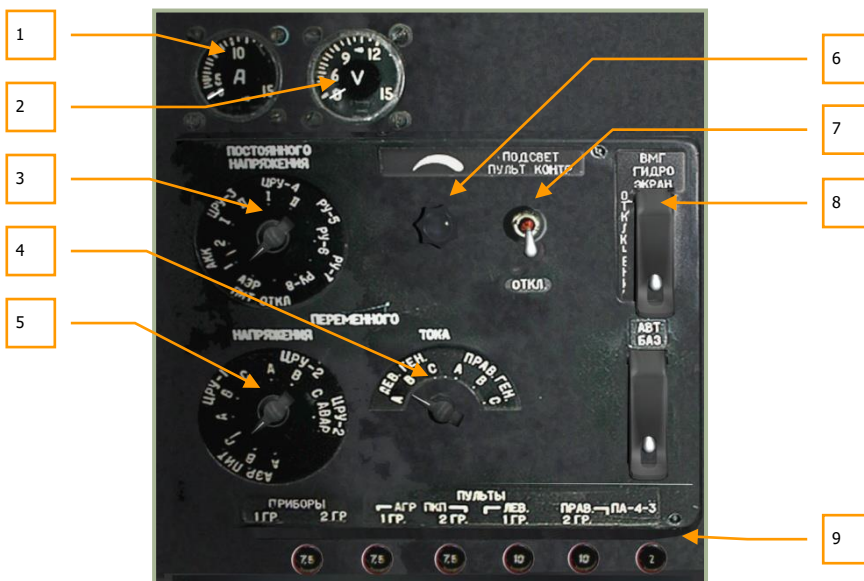
6-71: 电气系统控制面板
