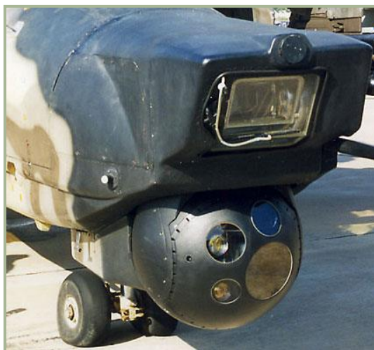
1-12: Ka-50Sh 的机鼻，“Shkval”系统在上，Samsheet-50 光电系统在下
