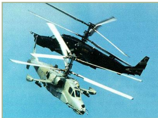
1-9: V-80（编号 012）装备有水星（Mercury）微光电视瞄准系统（于机头）
