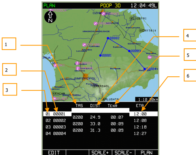
7-45: 输入起始航路点的出发时间和在航段上的真空速
