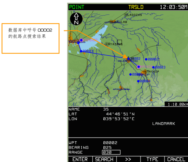
7-89: 搜索数据库导航点的结果，用于通过 BEARING 和 RANGE 画新的地图点
