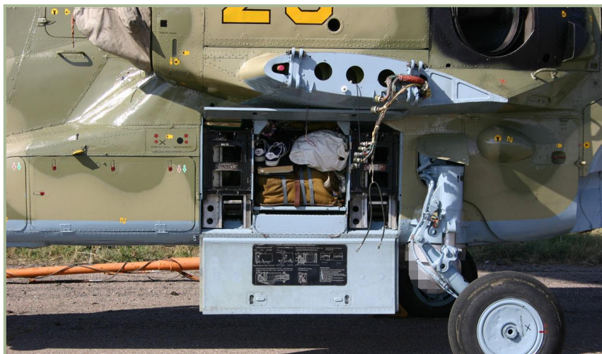
2-2: 拆卸了短翼并打开了检修盖的直升机
