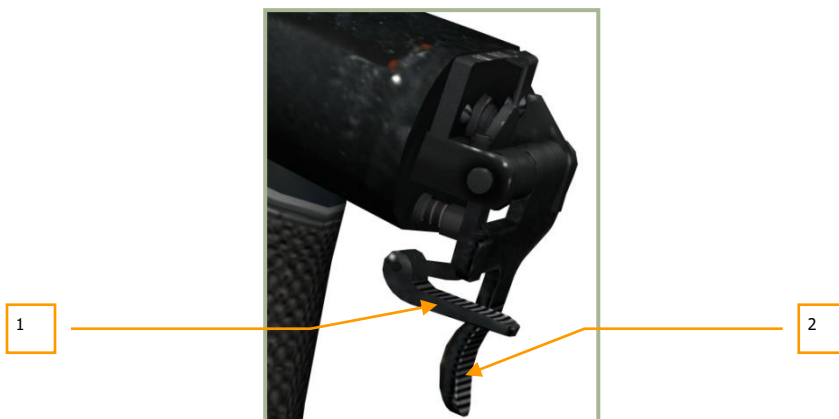
6-5: 武器（大）和机炮（小）扳机在默认位置 - 释放武器扳机操作
