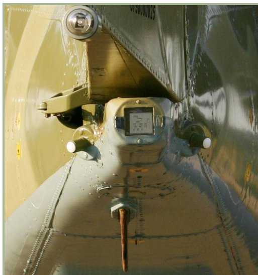
2-6: Ka-50 的机尾白色的导航灯位于照片的顶部。L-140 激光传感器系统位于中间，多种 IFF 天线位于两侧和底部
