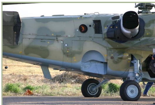
2-3: 正在运行的辅助动力装置 (APU) 的排气口和主发动机的屏式排气装置
