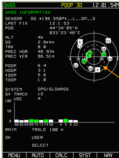
7-103: 修改海拔遮蔽后的 GNSS 页面
