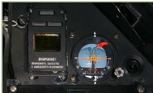
2-5: Ka-50 驾驶舱中的 Ekran 内置预警和控制系统（左）和辅助姿态指示器（右）。
