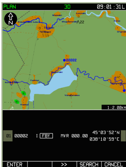
7-35: 成功使用编号完成导航点搜索后的 MENU/PLAN 子模式显示
