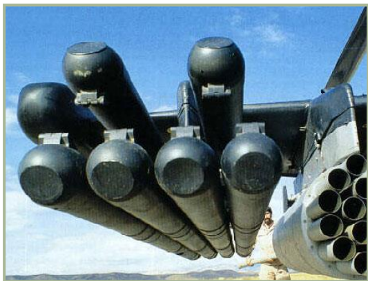
1-5: “旋风”反坦克导弹以及 APU-6 发射器
