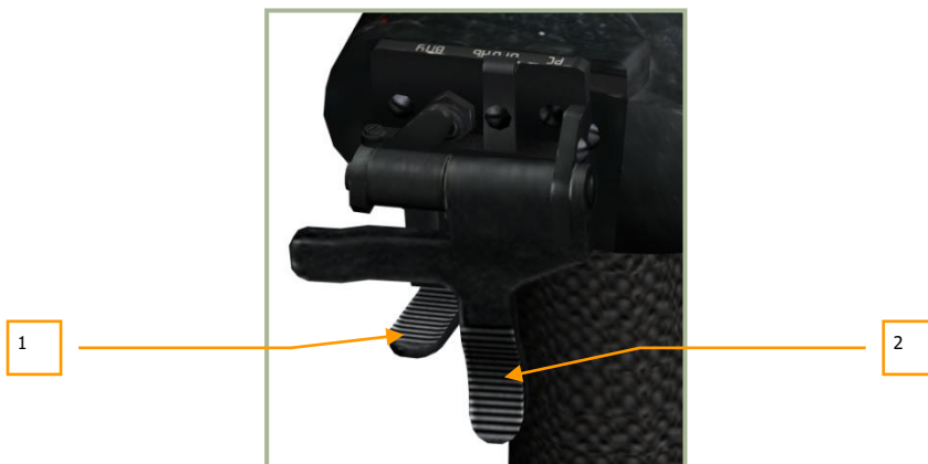
6-6: 武器（大）和机炮（小）扳机在默认位置 - 释放武器扳机操作
