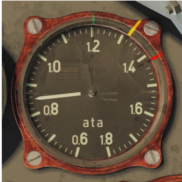
图 40：增压器压力表
