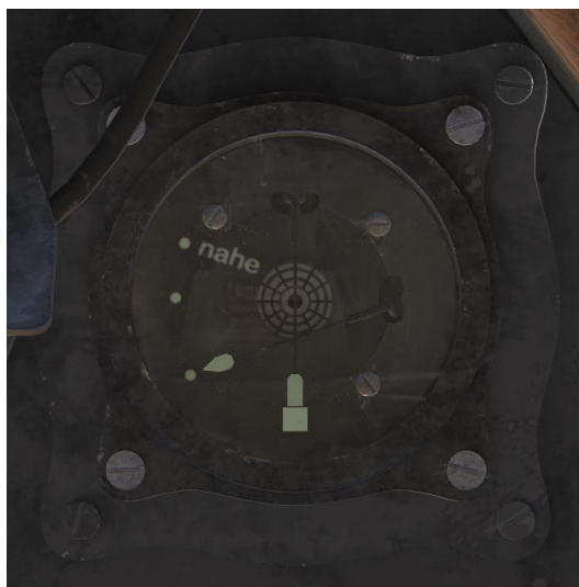
图 34: AFN-2 归航指示器
