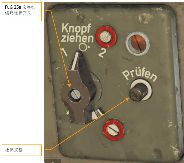
图 43: FuG 25a IFF 应答机
