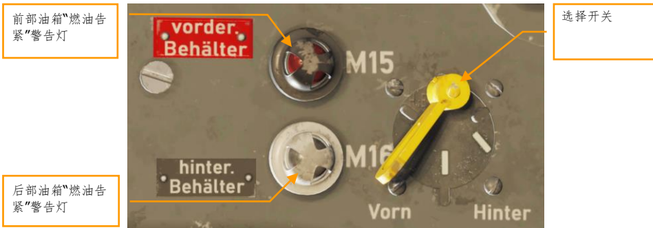
图 53：燃油警告灯（左）和燃油表选择开关（右）。
