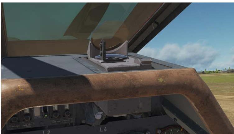
图 31: Revi 16B 射击瞄准具
