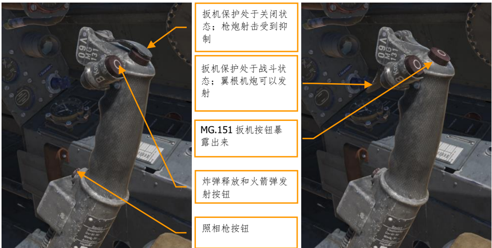
图80. 驾驶杆和按钮，扳机保护关闭（左）和打开（右）。
