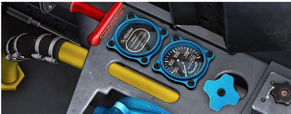
图 46：氧气示流器和压力表
