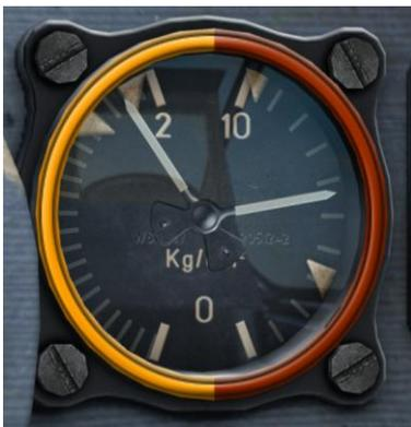
图 37: 燃油压力 (左侧) 表
