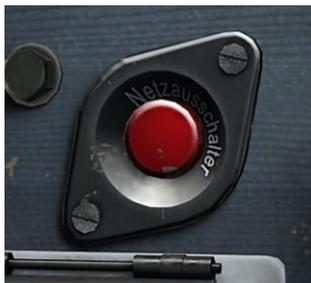
图 70：电源切断开关
