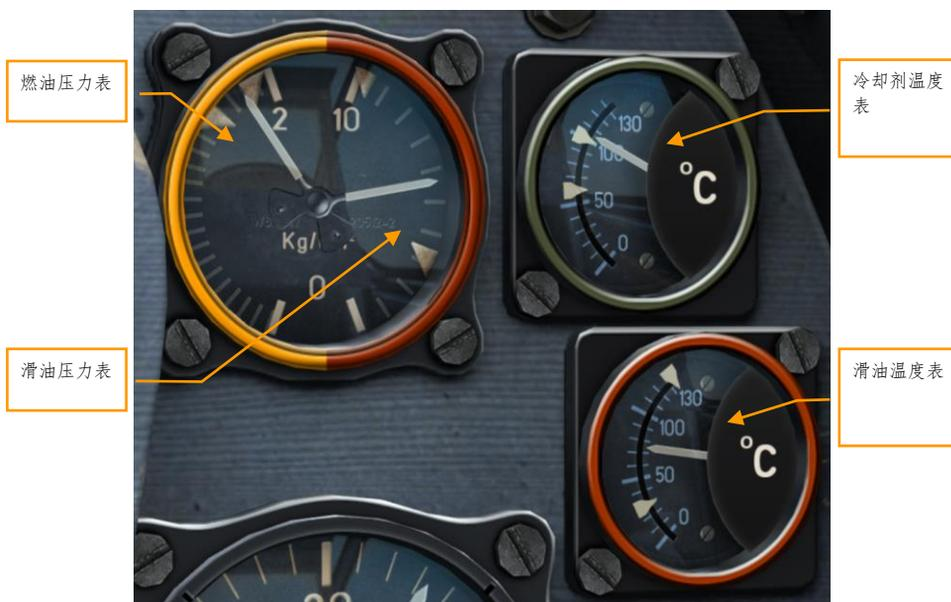
图 78：燃油和滑油压力表、冷却剂和滑油温度表
