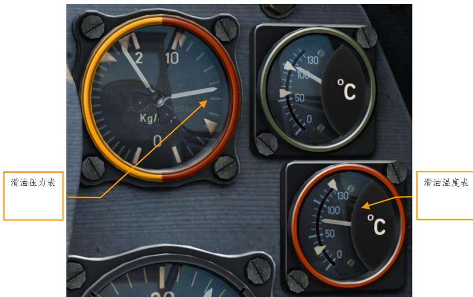
图 42：滑油压力（右）和滑油温度表
