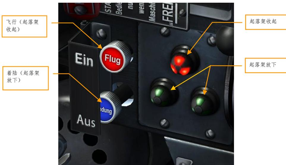
图 72：起落架控制器和起落架位置指示器
