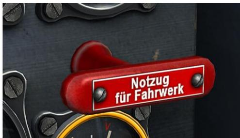
图 73：起落架手动释放
