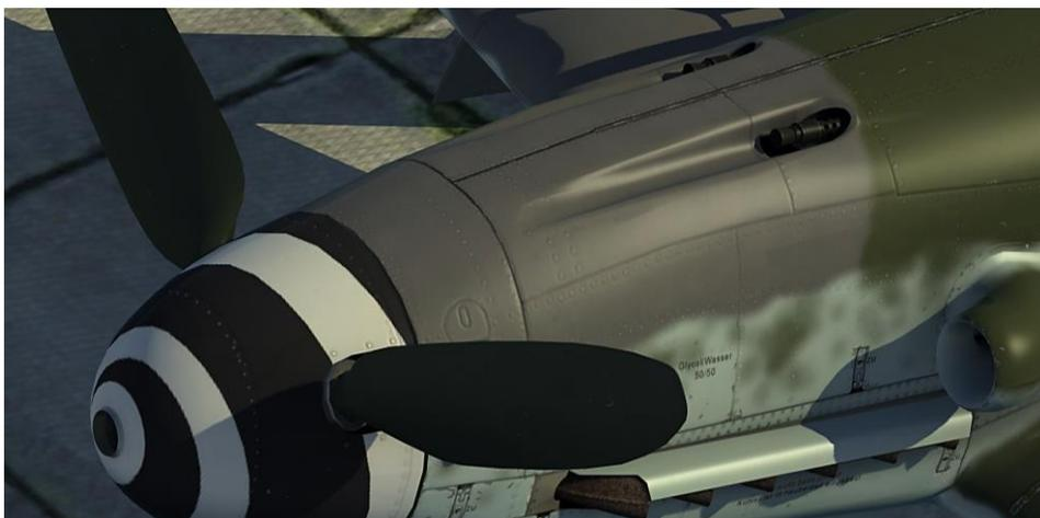
图 52: MK 108 发动机安装机炮和两挺发动机上的 MG 131 机枪
