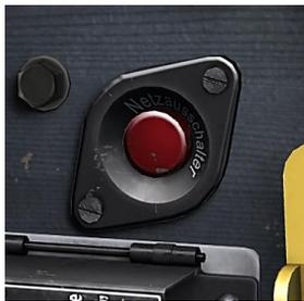
图 45: 电源切断开关
