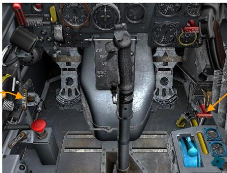
手动冷却剂阀控制（左）
