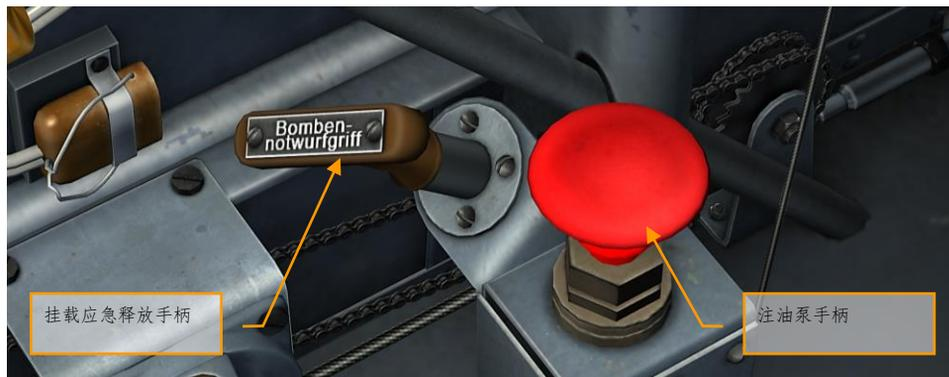
图 90：挂载应急释放和注油泵手柄
