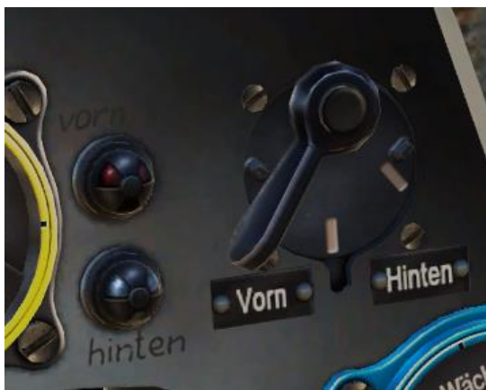
图 24: 燃油警告灯（左）和油量表选择开关（右）
